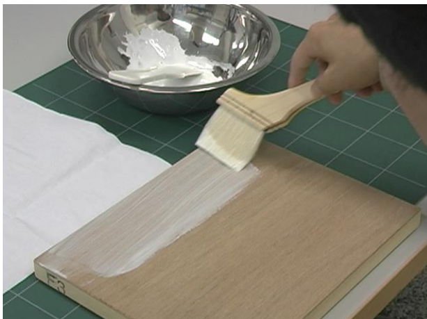
手順2. 土台となる側に、刷毛で端から塗っていきます。
