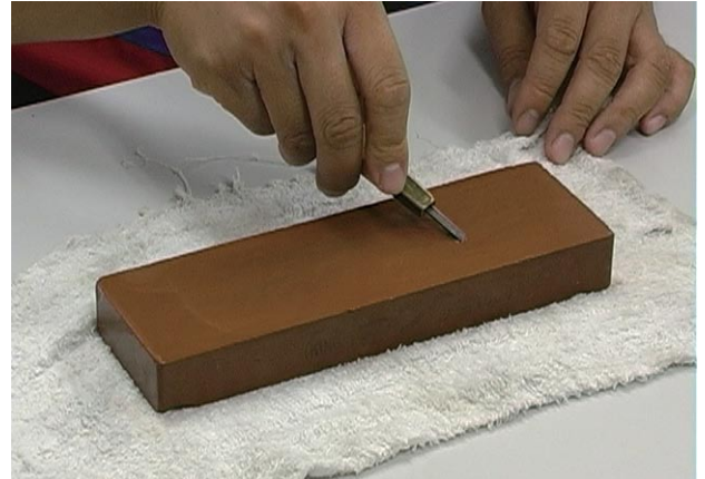
手順 7. 丸刀を研ぐ場合には、表刃の傾斜を砥石に当て半回転させて左右に8の字を描くように動かしながら研ぎます。
