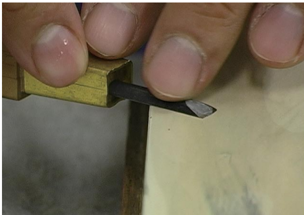
手順 5. 仕上げ砥石の場合にも研いだ際に刃の裏側にまくれができるため、裏刃を砥石面に平らに当てて軽く研ぐようにします。
