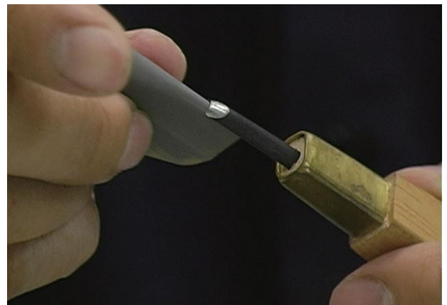
手順 9. 砥石棒は耐水ペーパーで代用することができます。研ぎ終わった彫刻刀はウエスでよく水気を拭き取ります。
