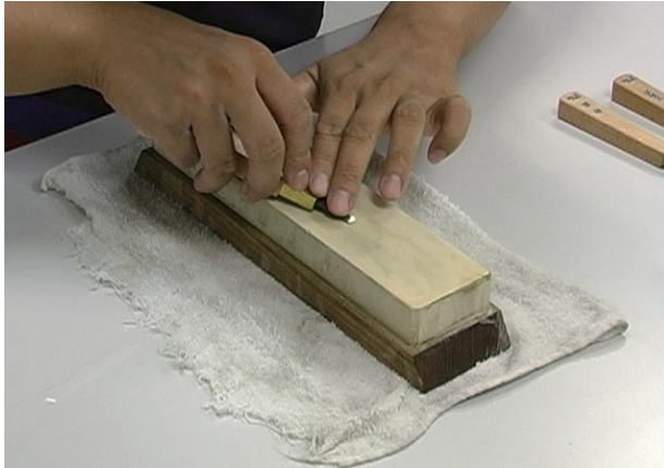
手順 4. 中砥石で刃の形状を整えることができたなら仕上げ砥石に移り、中砥石と同じ様に研ぎます。
