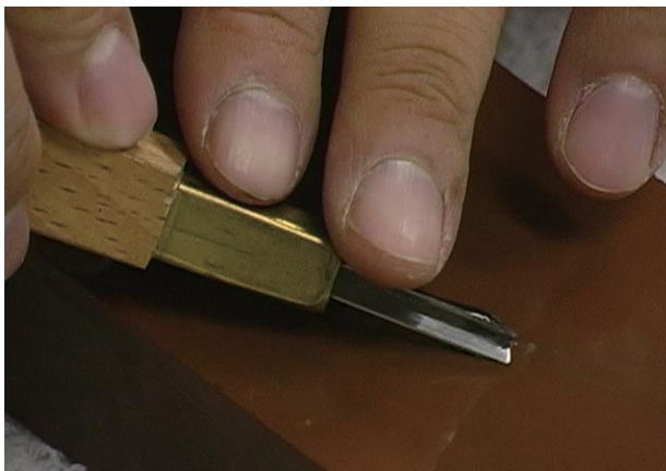
手順 6. 三角刀を研ぐ場合には、片刃ずつ刃の傾斜を砥石に平らに当てて研ぎましょう。
