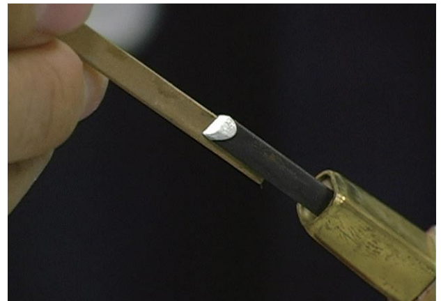
手順 8. 三角刀や丸刀の刃の裏側にできるまくれは、砥石棒で取るようにします。
