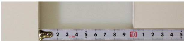
内法 (うちのり) を測る (押しつけて測る)
