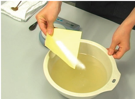
手順2. よくすり潰した生明礬5グラムを、薄めた膠液に少しずつ入れます。
