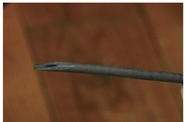
手順 5. カッターなどで、先端を削り、描きやすいように調整し、完成。
