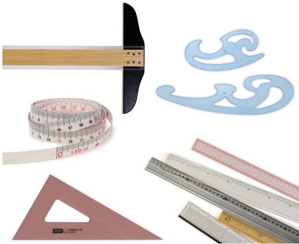
右上から時計回りに、雲形定規、直定規、三角定規、メジャー、T定規
