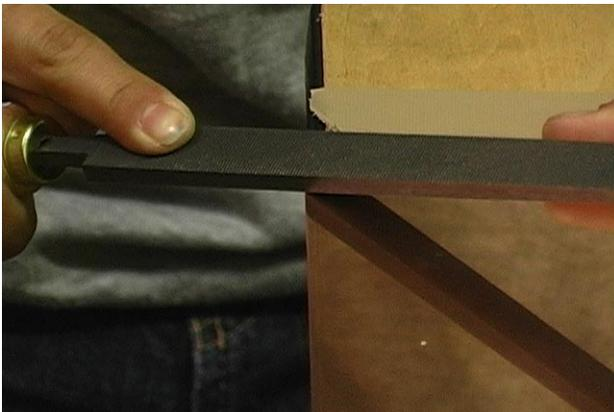
手順3. 金やすりで傾斜をつけていきます。幅2～3mm 傾斜30～45度程度が目安です。
