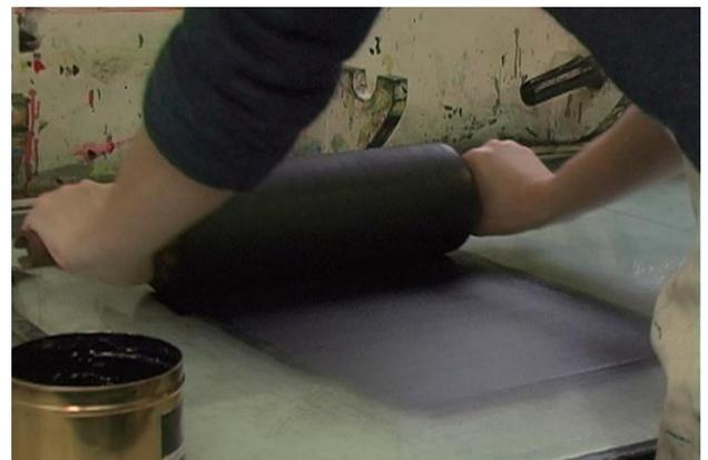
手順2. インク上をローラーで何度も前後に転がすことで、ローラー全面にムラ無く均一に製版インクを付着させます。
