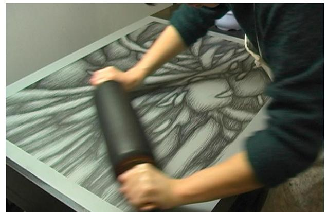
手順3. 金属版（アルミ版）の版面を隅々までローラーを転がしてムラなくインクを盛っていきます。このとき、製版インクは描画部分にのみ盛られ、画線が再現されます。また、製版インクのつき具合が印刷時にも影響するため、よく調子を整えます。
