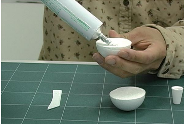
手順1. あらかじめ接着面の汚れを落とした後、接着面の両面に接着剤をつけます。
