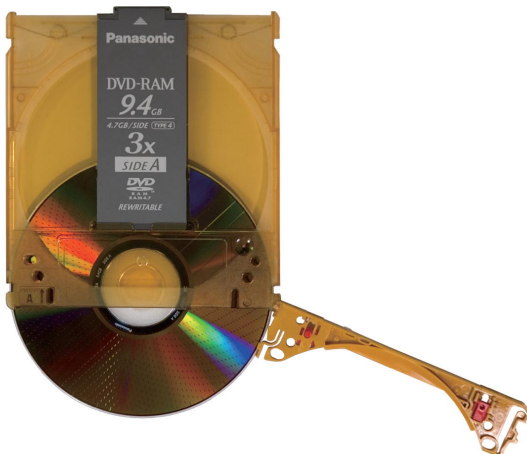
図3. カートリッジを開封してディスクを取り出せば、通常の駆動装置で利用することも可能です。
