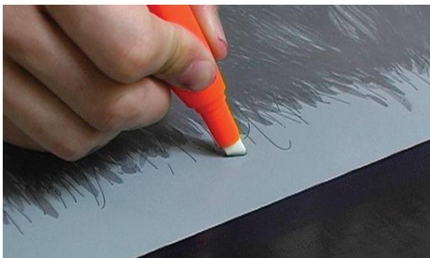
手順1. ケシロンは上記のようなエッチ液を用いた処理が不要で、消したい描画部分をペン先で軽く擦り消し、スポンジで拭き取るだけで消去することができます。
