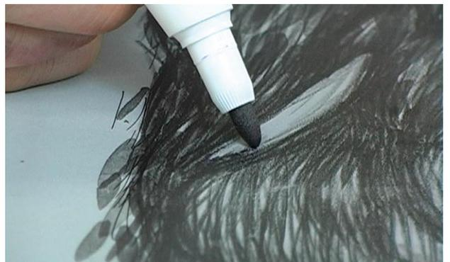
手順1. カキロンは上記のような整面・製版処理が不要で、加筆部分のアラビアゴムなどを水で完全に拭き取り乾かしてから、直接ペンで描き込むように加筆することができます。
