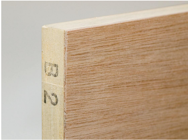
写真 1. 木製パネルの側面（厚さ：約 18 ～ 34mm 程度）
