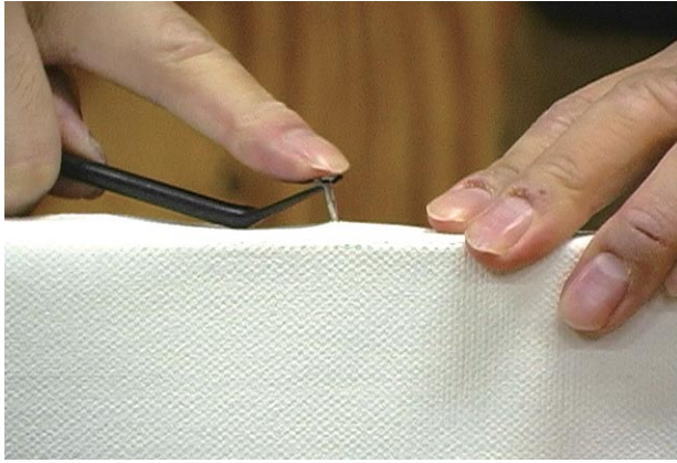
手順7. 仮留めし終わったら、再び最初に留めた片方の長辺中央のタックスに戻り、仮打ちしたタックスを抜きます。
