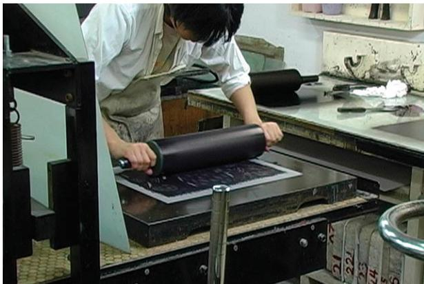
手順3. 水洗いした金属版（アルミ版）の版面が乾燥しないうちに手早くローラーを転がし、ムラなくインクを盛っていきます。インクの量は始めは少なめで、試刷りを3～4度繰り返すうちに徐々に増していき、インクの乗りが安定したら本刷りを行います。
